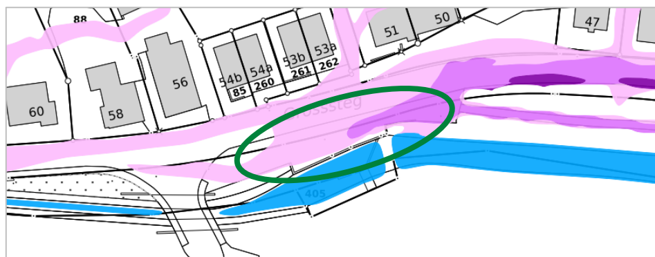
Abb. 9: Auszug Gefährdungskarte Oberflächenabfluss, Standort geplantes Infrastrukturgebäude (grün)
